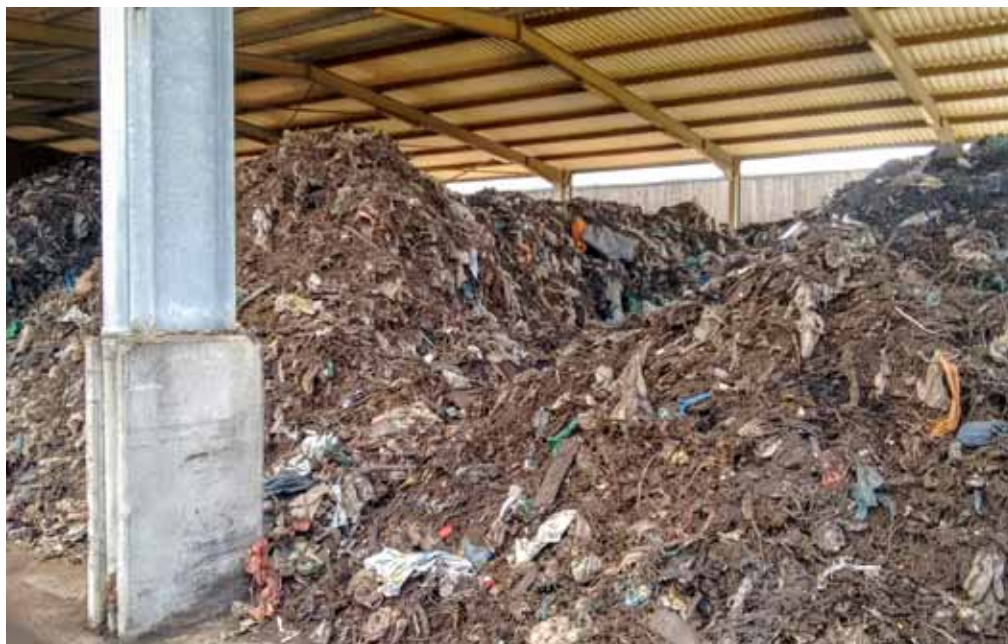
Abb. 23: Zu hoher Anteil an Störstoffen, hier Material aus Siebüberlauf.
