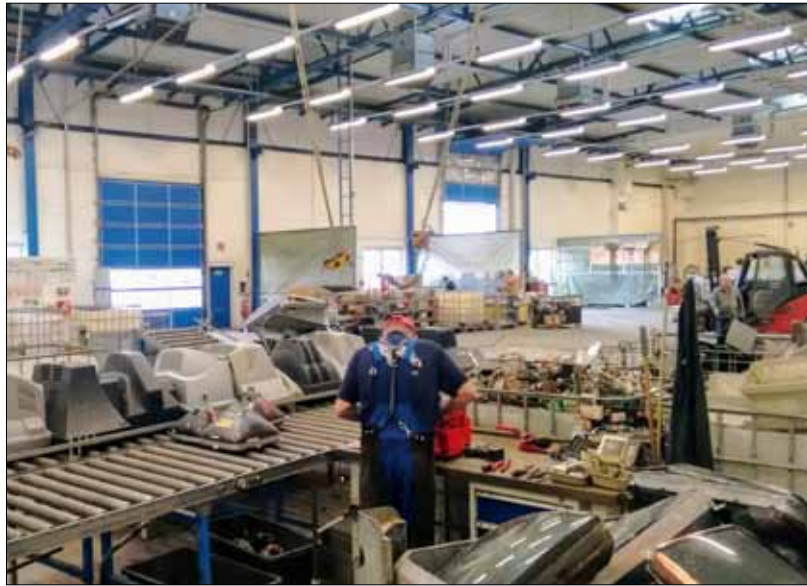
Abb. 70: Beschäftigte beim Zerlegen gesammelter Elektroaltgeräte
