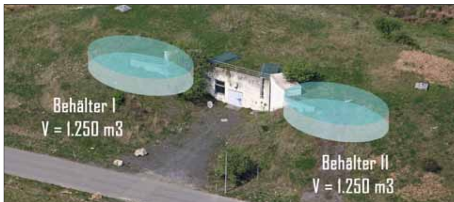
Abb. 9: Schematische Darstellung der Mengenausgleichsbehälter für Deponiesickerwasser
