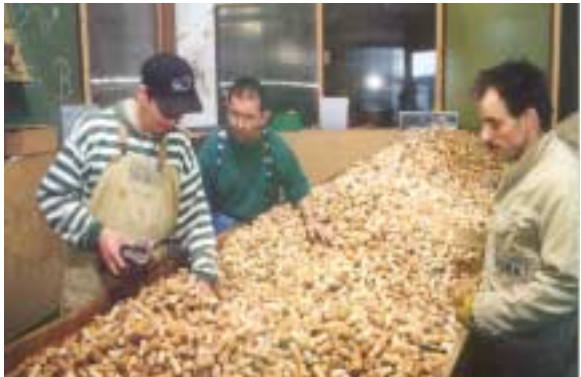
Mitarbeiter der Werkstatt für Behinderte unterziehen die Korken vor dem Schroten einer Sichtkontrolle
